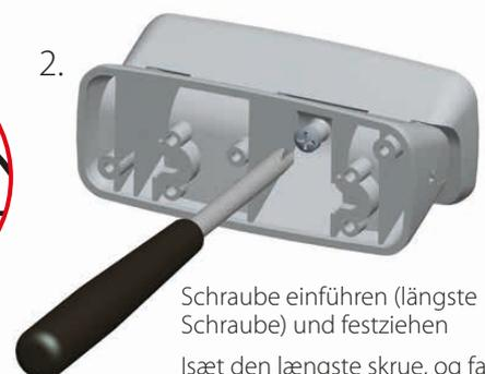
Skrube einführen (längste Schraube) und festziehen
